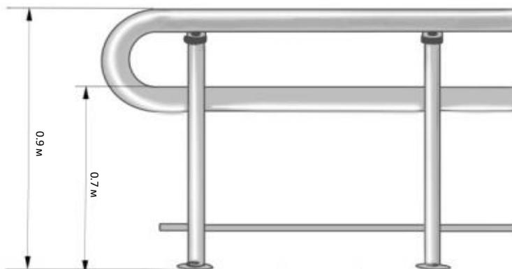
ограждение на отрезке прохода вдоль железнодорожного пути, пункт 8.4.11 СП 59.13330.2020
