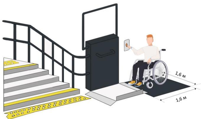
параметры свободной площадки перед платформой наклонного перемещения с криволинейной траекторией, пункт 6.2.17 СП 59.13330.2020
